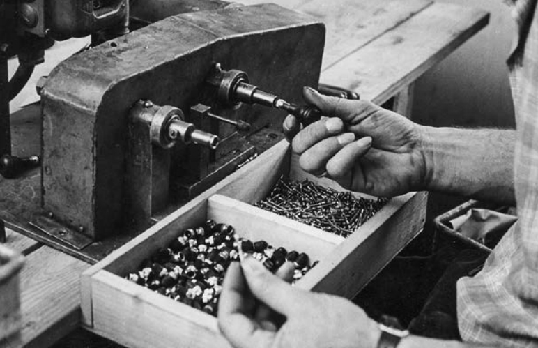
Ventilmontage in einer Werkstatt um 1970
